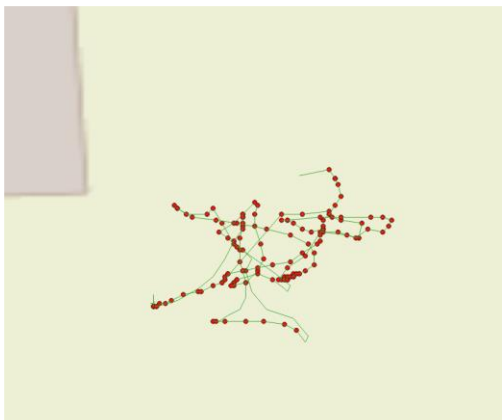
Figure 9 : exemple d'un essai du robot où les points rouges représentent les endroits où le système de pulvérisation s'est déclenché
