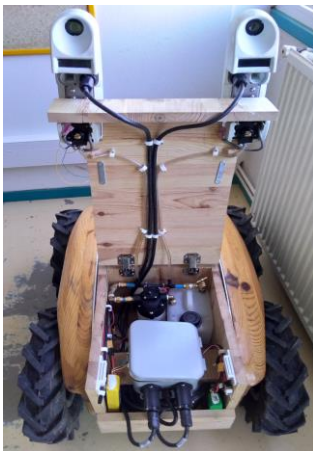
Figure 4 : circuit de pulvérisation du robot
